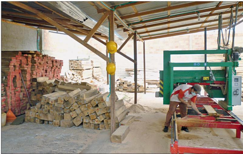
Abbildung 14 Viele Sägewerke nutzen horizontale Blockbandsägen oder vertikale Trennbandsägen als primäre Einschnittstechnologie.
