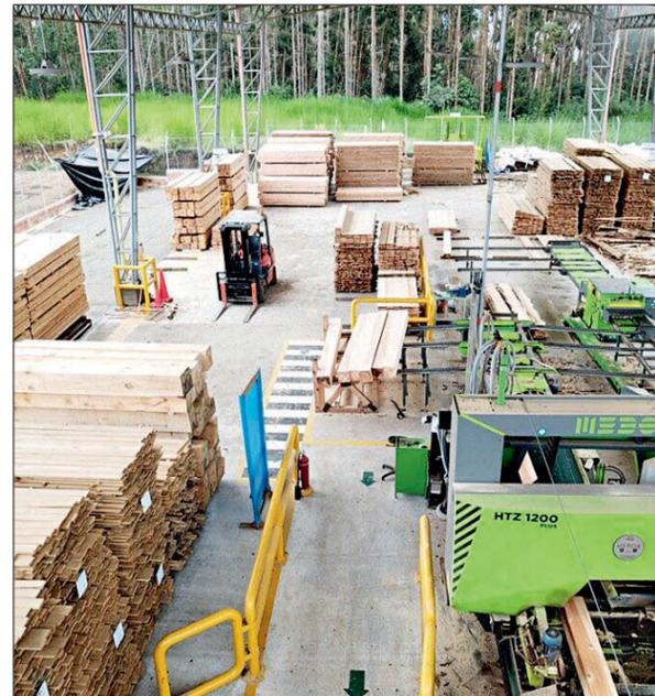
Abbildung 16 Modernes Blockbandsägewerk für den Einschnitt von Kiefer
