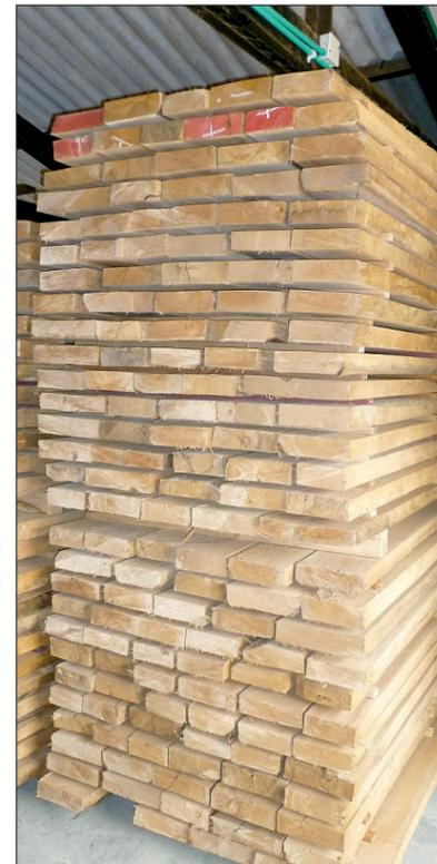
Abbildung 7 Kammergetrocknetes Schnittholz aus Plantagenteak (*Tectona grandis* L.) im Norden von Kolumbien
