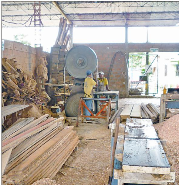
Abbildung 15 In vielen Sägewerken gibt es keine zentrale Absauganlage. Die anfallenden Späne werden täglich per Schaufel in tragbare Behälter entsorgt.
